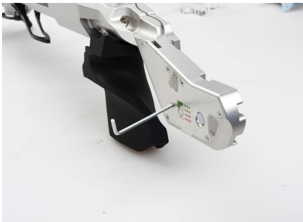
Abbildung 5: Stossen Sie die Batterie mit einem Inbusschlüssel durch das Loch aus der Halterung
